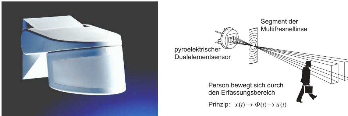
Abbildung 1: Busch-Wächter® MASTER 220, Funktionsprinzip eines PIR-Bewegungsmelders
