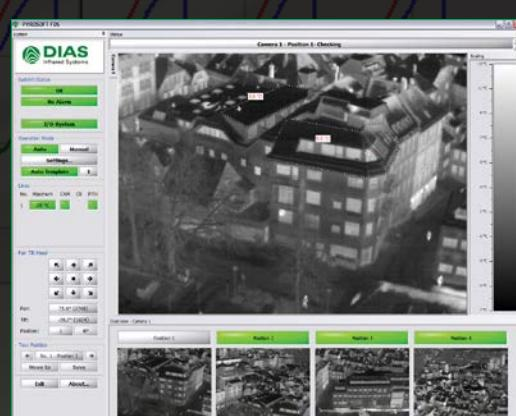
Für die Brandfrüherkennung: Nutzen Sie **PYROSOFT FDS** in Kombination mit dem intelligenten Brandfrüherkennungssystem PYROVIEW FDS um frühzeitig auf Brände reagieren zu können. Die Kameras können auf einem Schwenk-Neige-Kopf montiert werden und so den Überwachungsbereich in aufeinanderfolgenden Sektoren abdecken.
