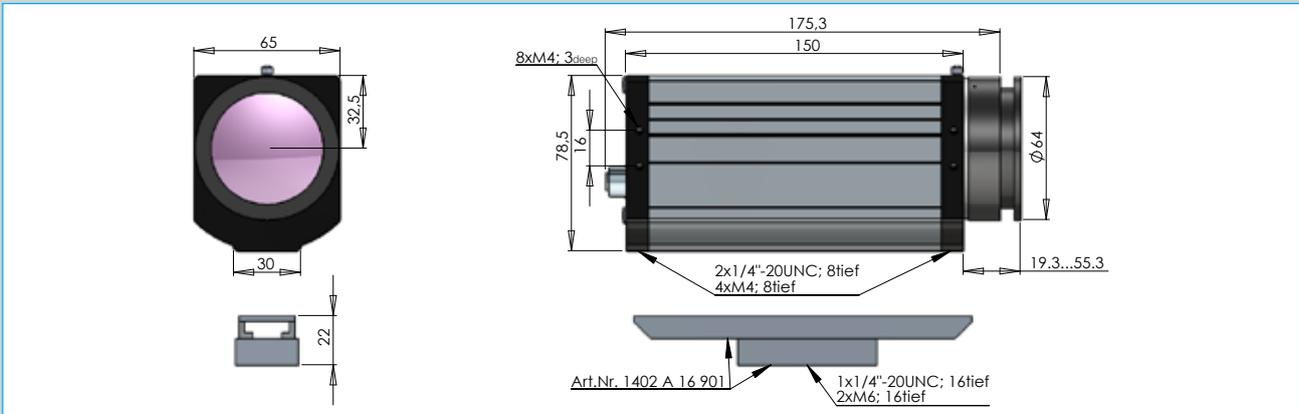
Abmessungen: PYROLINE 512N im „protection“ Gehäuse
